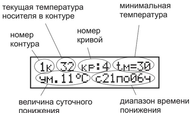
Рис.6. Экран установки параметров контура
