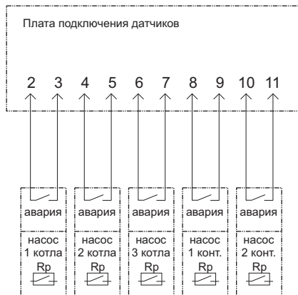
Рис. 2.7. Схема подключения некоторых датчиков технологической сигнализации
